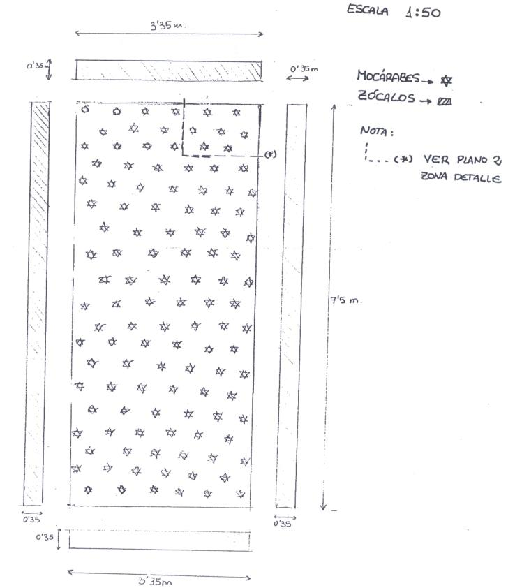
ESQUEMA QUE SE REPITE CONSTANTE E INVARIABLEMENTE EN TODO EL TAUJEL. (SALVO ZÓCALOS LATERALES) PLANO Z. DETALLE MEDICIONES
